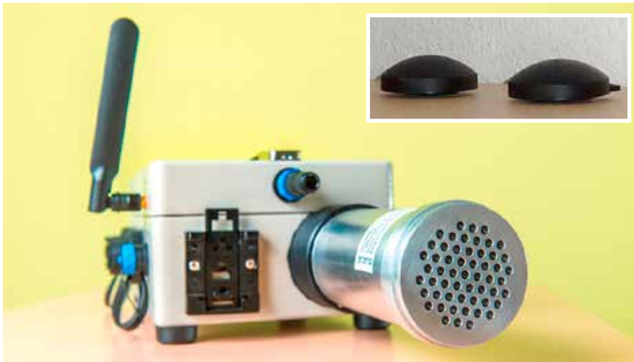
Abbildung 2: Radonmessgeräte: Radonmonitor und passive Dosimeter (kleines Bild).
