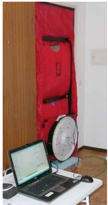
Abbildung 3: Luftdichtigkeitsmessung mit dem Blower-Door Verfahren.
